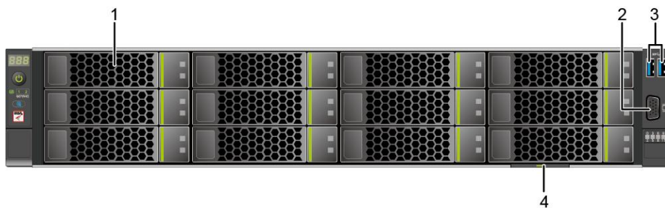
图 5-1 12x3.5 英寸硬盘配置前面板组件
