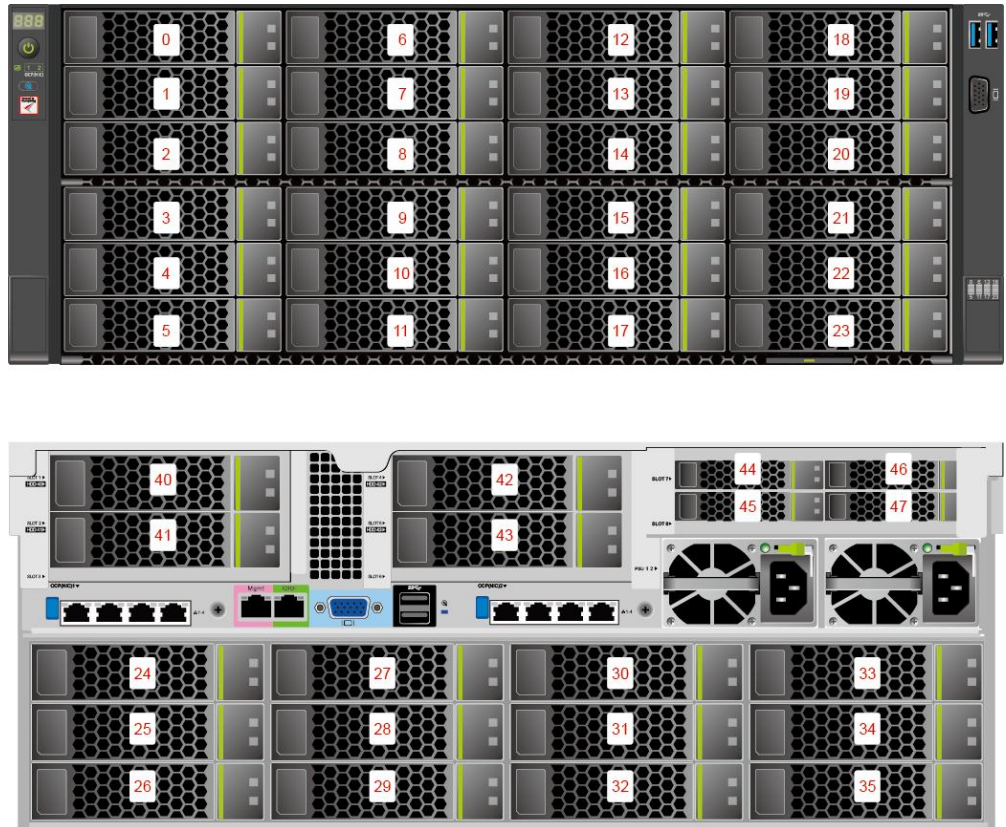
图 3-7 36x3.5 英寸 EXP 机型的硬盘编号
