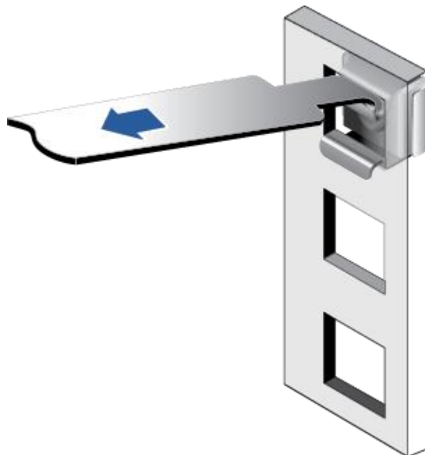
图 5-6 在机柜中安装浮动螺母
