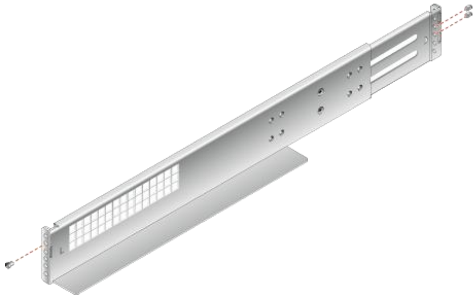
图 5-10 安装限位销钉
