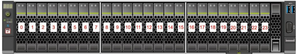
图 3-22 24x2.5 英寸硬盘 RAID 直通配置的硬盘编号
