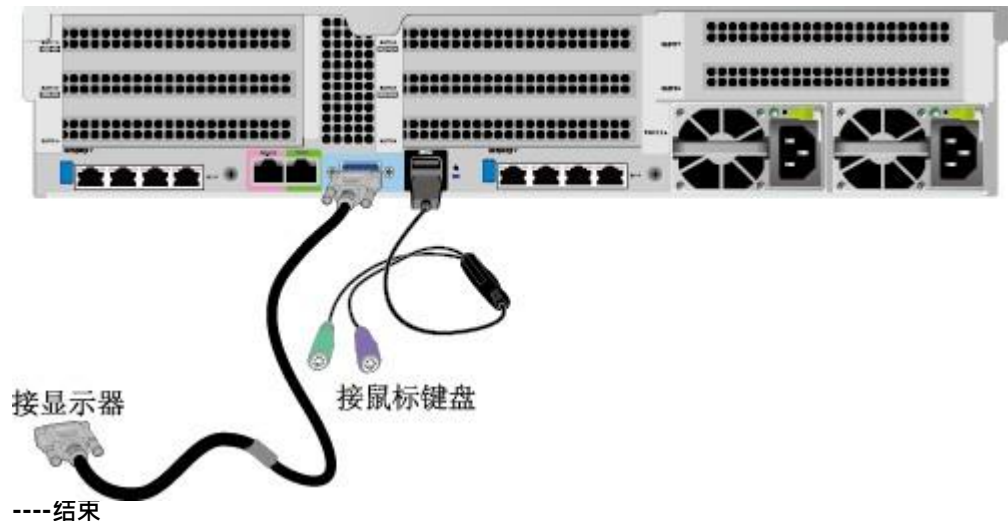
图 6-16 连接 USB 转 PS2 线缆和 VGA 接口
